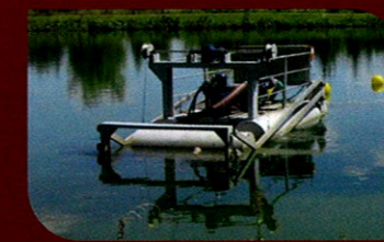
Barge de curage
